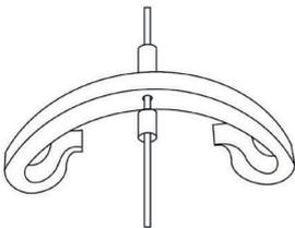
Abb. 2: Befestigungsclip für das Tragseil
