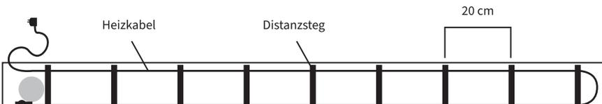
Abbildung 5: Endmontage in einer Dachrinne
